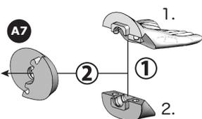
2 22.まで組み進めたら、センターポール(長)を前方より差し込み、組み立てキーを使用して時計回りに回して固定してください。
