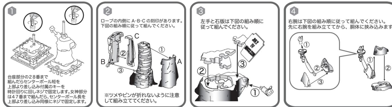
センターポールのネジ部分は強く締め過ぎないでください。材質上、破損する恐れがあります。
